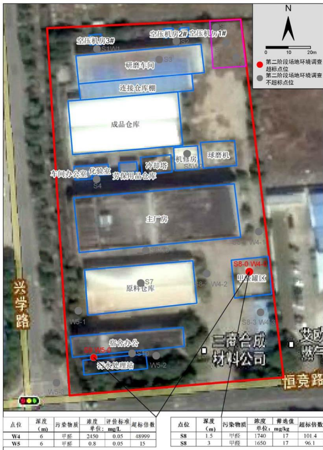
图 2-14 场地地下水采样点及超标数据
