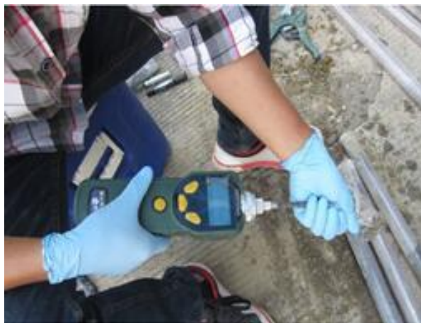
图 6-4 光电离子化检测器（PID）
